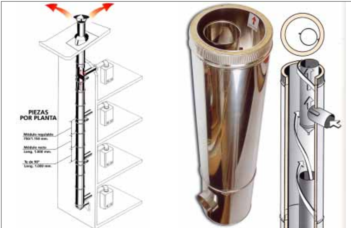
Figura 22: Chimenea Modular Metálica para Calderas Atmosféricas. Conducto Auxiliar interior recto. Fabricante NEGARRA
